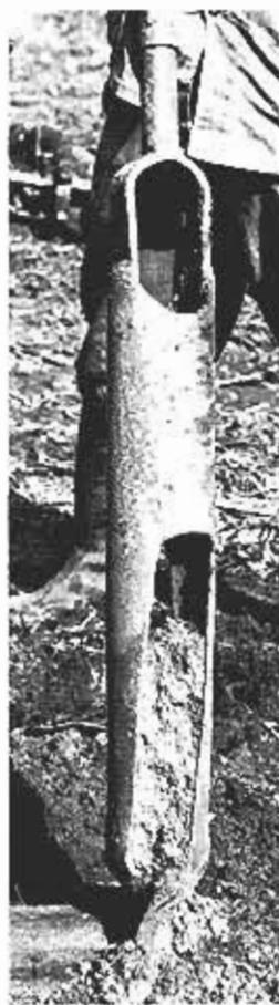
Abb. 5. a) Bohrung mit Löffelbohrer; b) Gezogener Löffelbohrer mit Substrat.
